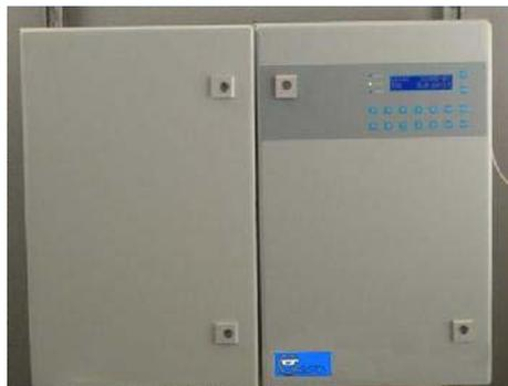
**MICROMAC TOC NDIR** est un analyseur en ligne contrôlé par microprocesseur, spécifiquement destiné à la surveillance automatique du COT/TOC dans différents types de matrices aqueuses.
